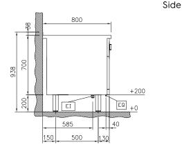
Electrical inlet (power) Equipotential screw
